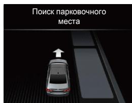
1. При включенной передаче D нажмите на переключатель системы полуавтоматической парковки, чтобы включить функцию параллельной парковки и выполнить поиск парковочного места (в качестве примера показана парковка справа).
